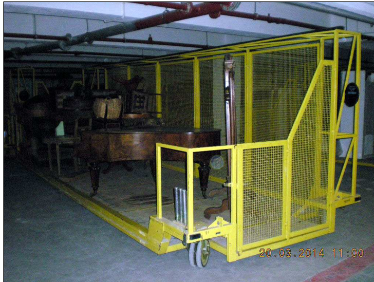
Wózek do transportu dekoracji o wym. 7530×2300×2210 mm (szerokość×głębokość×wysokość), średnica kół jezdnych Ø270 mm
