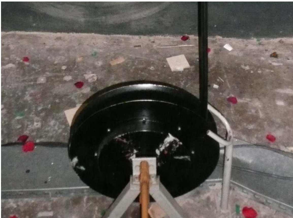
Fot. 29. Bęben z elastycznym hydraulicznym przewodem podwójnym
