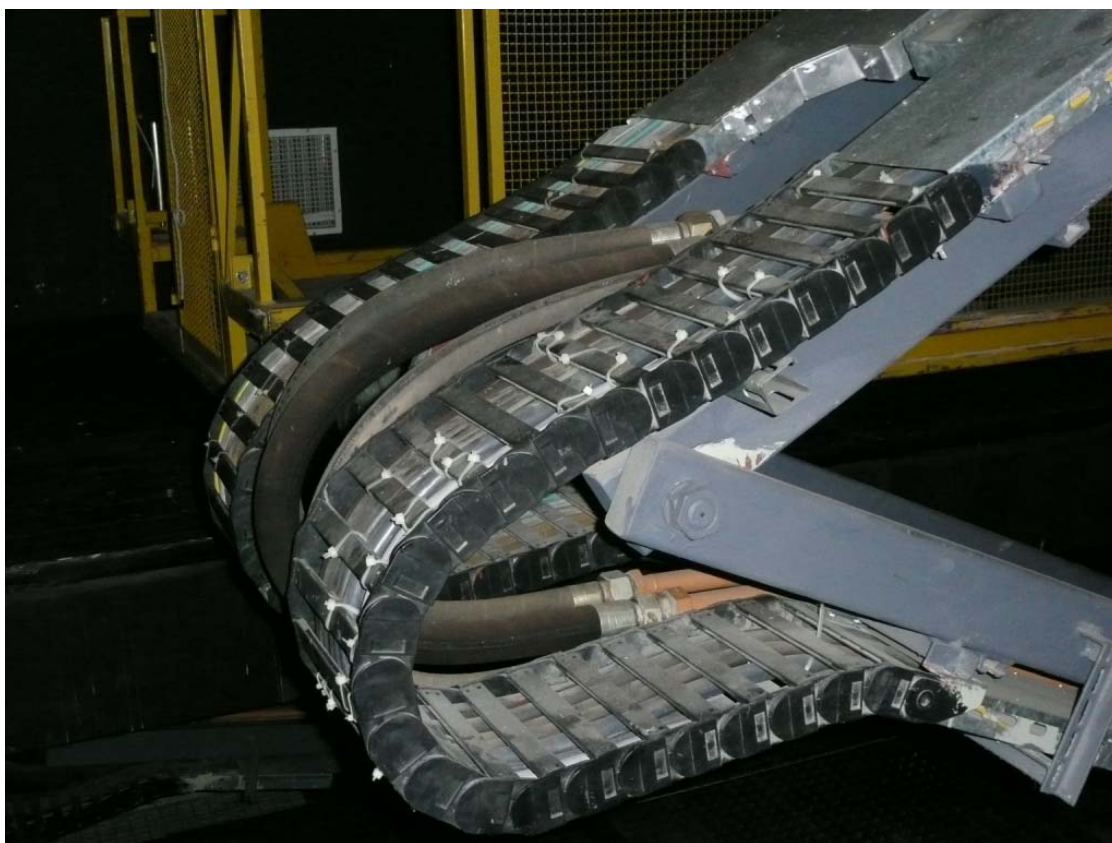
Fot. 25. Elastyczne przewody hydrauliczne środkowego przegubu podłogi wleczonej
