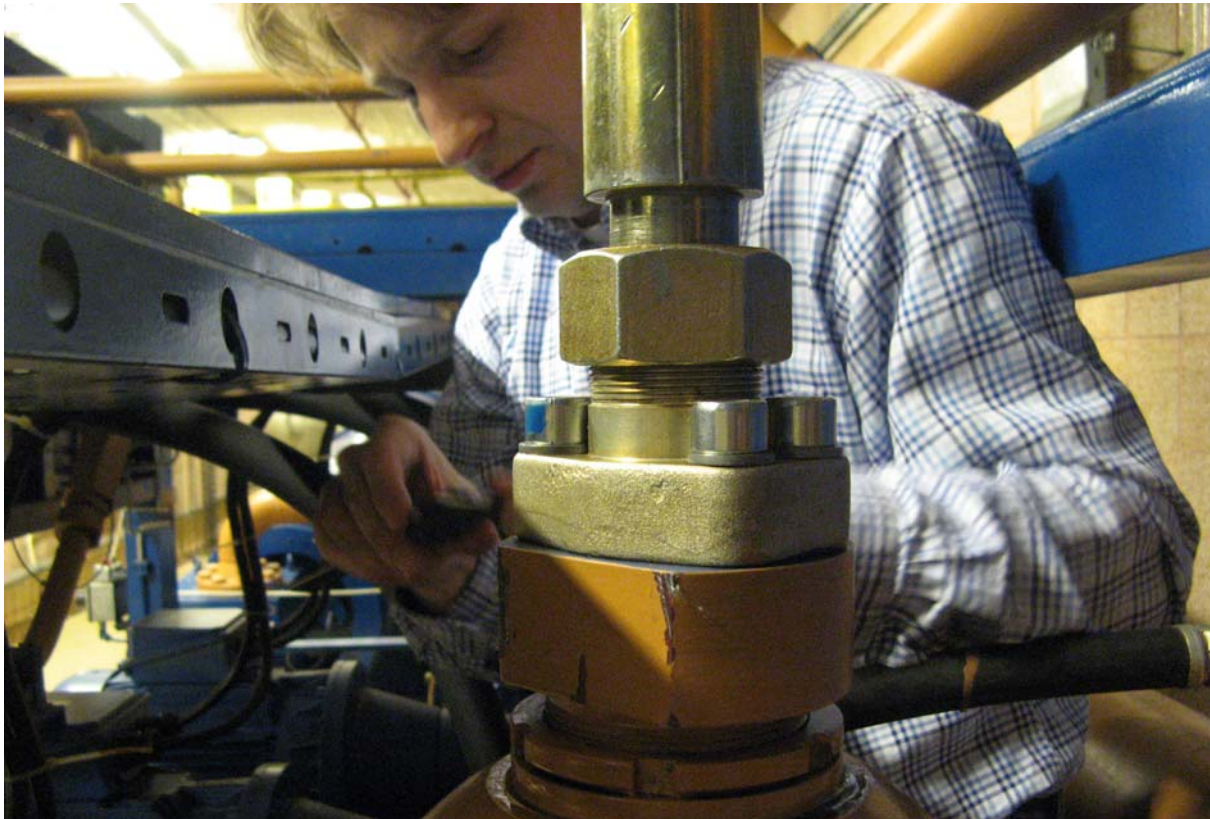
Fot. 38. Elastyczny przewód hydrauliczny wychodzący z tłumika drgań
