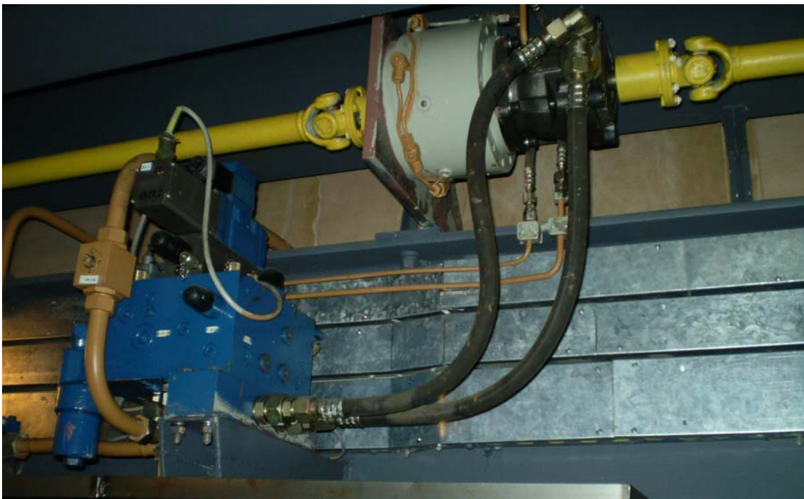
Fot. 21. Elastyczne przewody hydrauliczne mechanizmu pochylecia platformy – widok ogólny (zakończenie dolne i górne)
